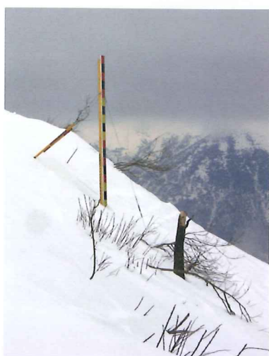
Fig. 11 - Una delle cinque aste nivometriche, installate ad opera del Consorzio Forestale Alta Val di Susa.
